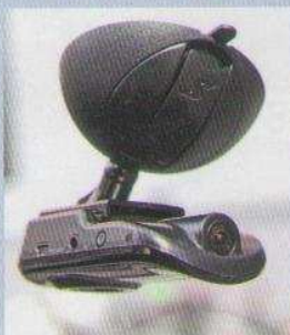
Niewielka kamera umieszczona na przedniej szybie zaczyna nagrywanie, gdy przekreślisz kluczyk
